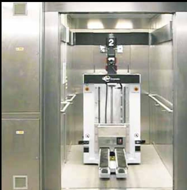
Axel a été le pionnier d'une technologie intelligente qui interagit avec les systèmes robotiques et permet aux robots d'assumer le contrôle total des opérations de l'ascenseur. Les entrées et les sorties sont communiquées via la technologie CAN Bus du microprocesseur de l'ascenseur au panneau d'E/S du robot WAGO Panel connecté au serveur hôte.
